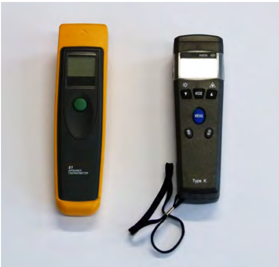
Abb. 48 IR-Thermometer für berührungslose Temperaturmessungen
