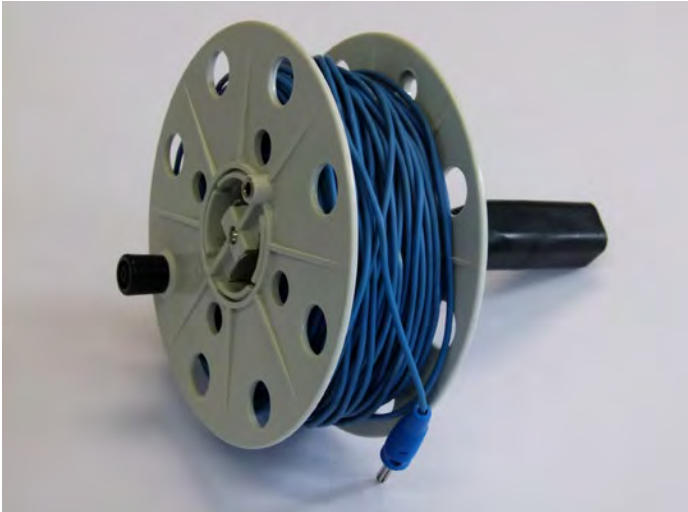
Abb. 45 Lange Messleitung auf Spindel für Schutzleiterwider- standsmessungen
