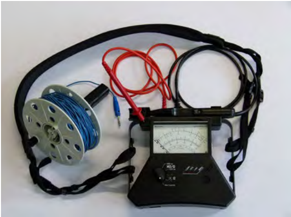
Abb. 27 Prüfgerät zur Ermittlung des Schutzleiter- und Isolationswiderstandes mit Analoganzeige und langer Messleitung auf Spindel
