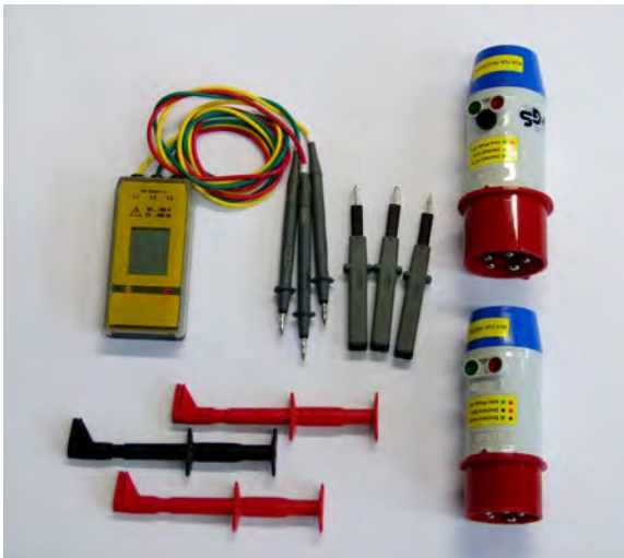
Abb. 42 Drehfeldprüfgerät, Prüfspitzen und Prüfadapter für Drehstrom- Anschlüsse
